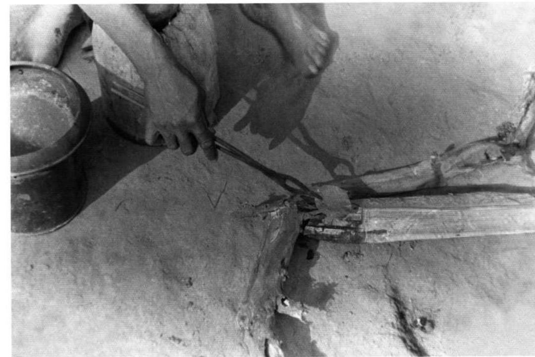
239 Glühen von Goldplättchen, das zur Folie geschlagen wird
