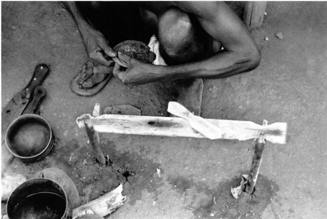
217 Messingguss: Formen von Wachs auf einer kleinen Werkbank
